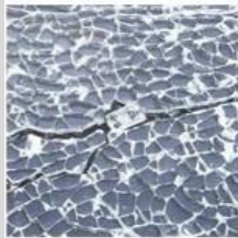
強化ガラスの割れ
